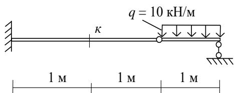
Определить значение изгибающего момента в сечении «к» используя аппарат линий влияния
