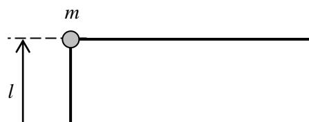
**Задача 2.** Определить технический коэффициент для металлической шарнирно опорной балки из двутавра № 24, находящейся под действием вибрационной силы  $F = F_0 \sin pt$ , приложенной к массе весом  $2l$  12 кг, при следующих исходных данных:  $p = 30 \text{ с}^{-1}$ ,  $E = 2 \cdot 10^{11} \text{ Па}$ ,  $I = 3800 \text{ см}^4$ . Весом пренебречь.
